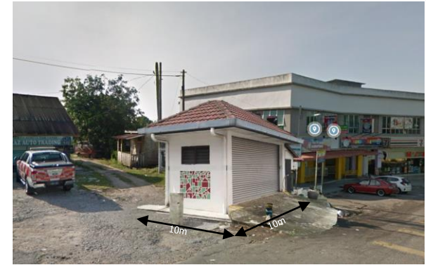
Cadangan Rumah Sampah (saiz 10mx10m) yang dilengkapi dengan sistem parit, perangkap sampah dan minyak.
